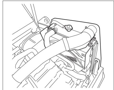
(3) 冷却水の減り具合が著しいときは、ラジエータ、ラジエータホースなどからの水もれがないか点検してください。
