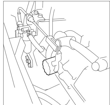
(3) 新品のカートリッジのガスケット（Oリング）に、「エンジンオイルを薄く塗布」します。
