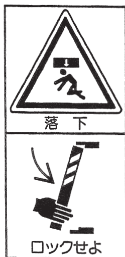
① 安全ラベル：警告（落下）
