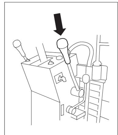
▶ **補足**：振動転圧は、エンジン回転を $2200\text{min}^{-1}$ （rpm）以上で行ってください。
