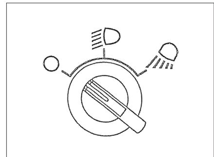
▶ 補 足 : 作業灯は「道路運送車両の保安基準」第42条(灯光の色等の制限)において「走行中に使用しない灯火」とされ、点灯したままでの道路走行は他の交通車両の妨害となることから、道路走行中の点灯は禁止されております。
