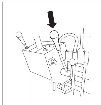
左右の前後進レバーに付いているスイッチでも振動のON-OFF (入-切) を行うことができます。スイッチを押すと振動します。再度スイッチを押すと振動は停止します。
