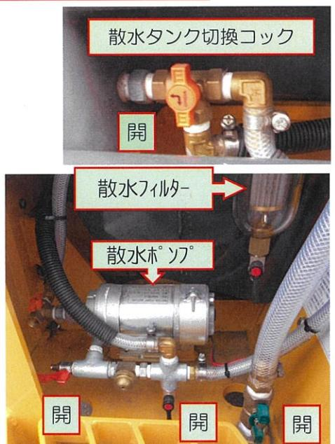
STEP ② 散水ポンプのドレンコック(橙色)、散水フィルターのドレンコック、前後散水パイプのドレンコックを開き水を抜きます。
