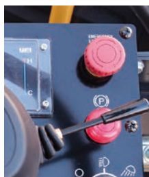
緊急停止ボタン
