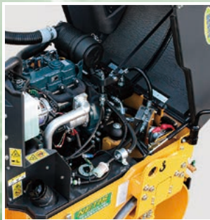
吸音材付フルオープンボンネット 18.2kWのパワフルなエンジン
