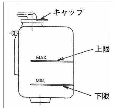
(3) 冷却水の減り具合が著しいときは、ラジエータ、ラジエータホースなどからの水もれがないか点検してください。
