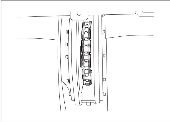
後輪後側のカバーを外し、潤滑油をローラーチェーンのたるみ側のピン、および内リンクの間隔を狙って油差し、またはブラシで給脂してください。
