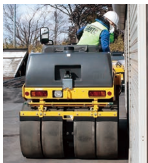
壁際走行でも検知エリアに対象物が入ると緊急停止。
