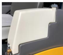
散水配管用不凍液タンク
