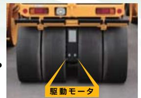
後輪2モータ駆動により、コーナリング時のタイヤの引きずりを軽減し、標準装備のデフロックで不整地での安定作業が可能（コンバインド）
