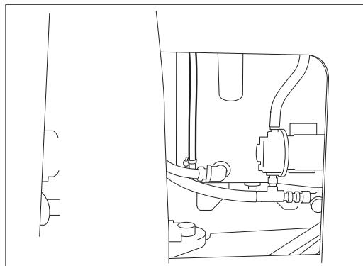
(2) 後輪タイヤへの液剤噴霧は散油スイッチを押すと液剤噴霧がされ、スイッチから手を離すと自動的に止まります。
