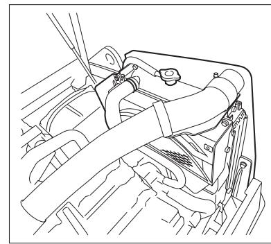
(2) 冷却水は「MAX-MIN」の間にあれば適量です。
