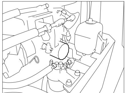
(2) カートリッジ型エレメント（以下カートリッジ）を、反時計方向に回して取外します。
