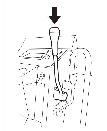
▶ **補足**：振動転圧は、エンジン回転数を $2200\text{min}^{-1}$  (rpm) 以上で行ってください。
