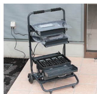
● 屋外充電器セット充電中 * コンセント容量 充電器1台につき15A以上必要
