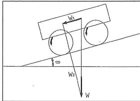
駐車ブレーキの取付け位置も重要な問題です。前図で坂の上方のローラドラムに取り付けても、坂の下方のローラドラムは回り出し、上のローラドラムを引きずりながら落ちます(路面が硬いほど引きずられやすくなります)。したがって、本機においては駐車ブレーキは後輪についておりますので、坂道に止める時は、後輪が坂の下方になるようにしてください。
