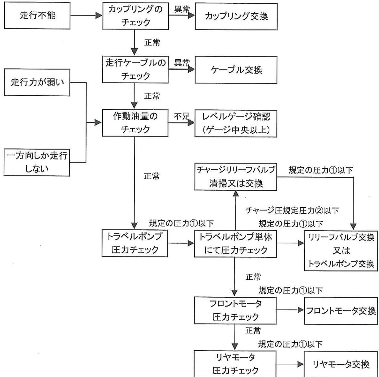
☆ 規定圧力 ①  $13.7^{\pm 1}\text{MPa}$  ( $140^{\pm 10}\text{kgf/cm}^2$ )
