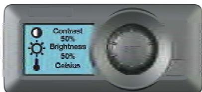
ディスプレイの設定と温度計を調整するには、ディスプレイ設定スクリーンが表示されるまでSETボタンを押してください。そしてSETボタンを時計回りか、反対回りに回して設定を調整してください。
