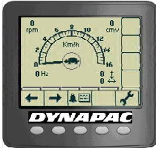
図. ディスプレイでは中央に選択されたギアポジション (カメ、ドラムスピン、ホイールスピン、又はウサギ) が表示されます。
