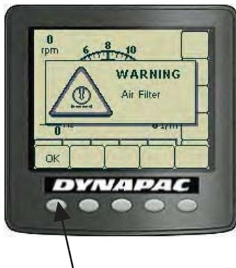
機械警告が作動した時、警告がディスプレイに表示されます。内容を確認して下さい。
