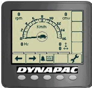
図. ディスプレイは中央に選択されたギアポジション (カメ、ドラムスピン、ホイールスピン、或いはウサギ) を表しています。
