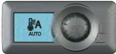
SET/SELECTボタンを温度調節モードのアイコンが表示されるまで押してください。そして、ボタンを必要なモードが表示されるまで回してください。
