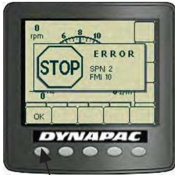
エンジン警告が作動した時、警告がディスプレイに表示されます。
