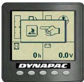
上記機能を作動させるためには必ず機械を作業モードにしてください。
