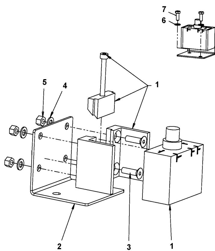
**Inclination sensor module**
